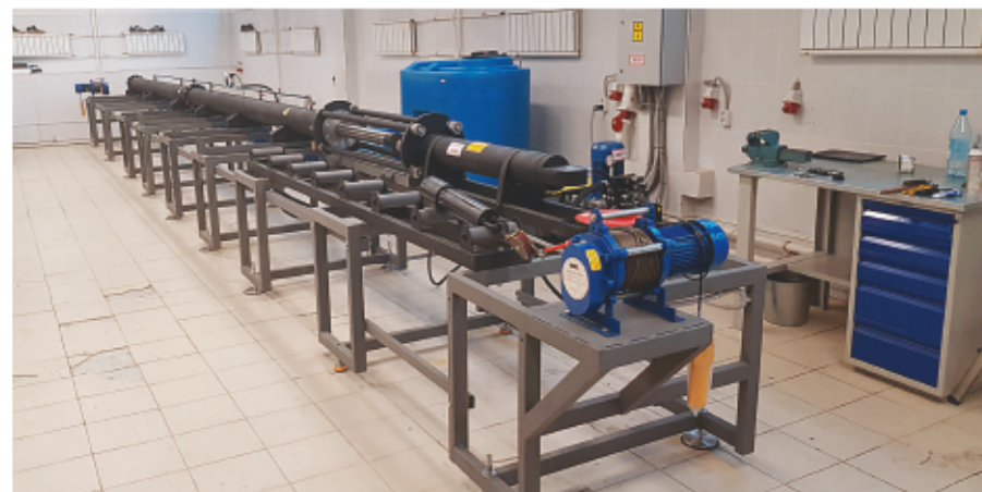
Стенд проверки тампонирующей пакерной системы.
